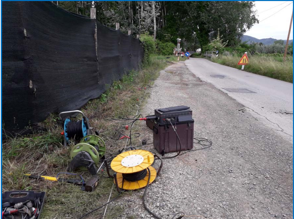
Vista dello stendimento MASW: sullo sfondo il penetrometro utilizzato per l'energizzazione
