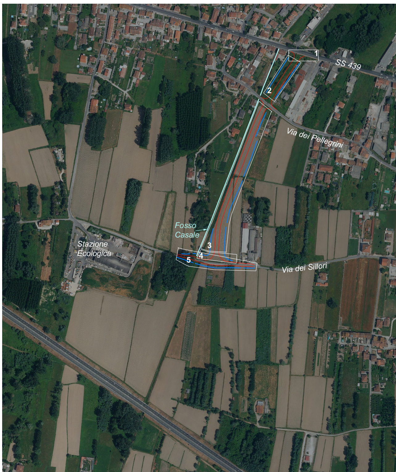
L'area dell'intervento su OFC-AGEA2019, 1:5.000. In bianco i 5 settori che compongono il progetto definitivo; in rosso l'area del nuovo manufatto stradale; in azzurro i fossati laterali
