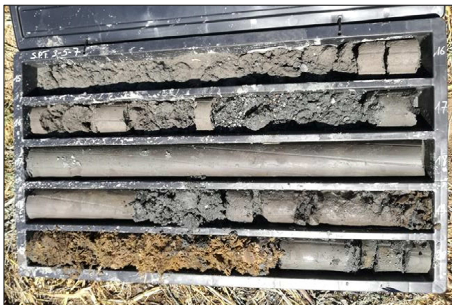
Fig. 5: Sondaggio S1-Pz – Cassetta 4 (15,00 – 20,00 metri)
