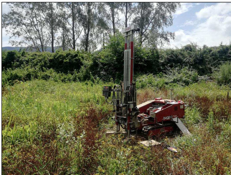
Fig. 6: Postazione della prova penetrometrica statica PS.1
