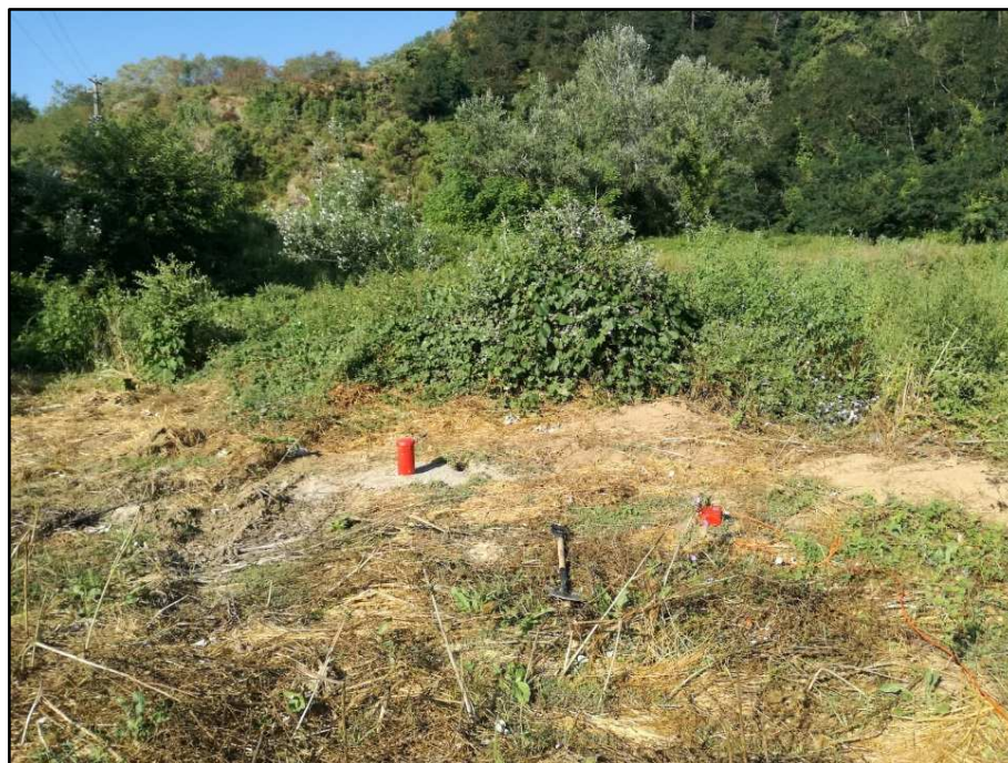
Fig. 9: Postazione misura di rumore ambientale a stazione singola (HVSr)
