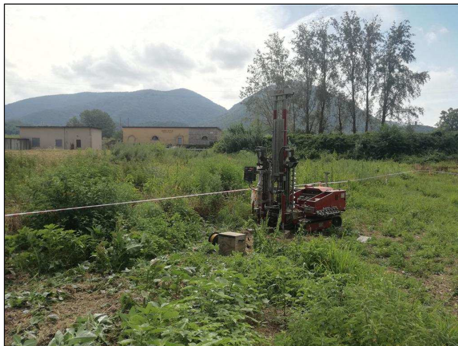
Fig. 7: Postazione della prova penetrometrica dinamica PD.2
