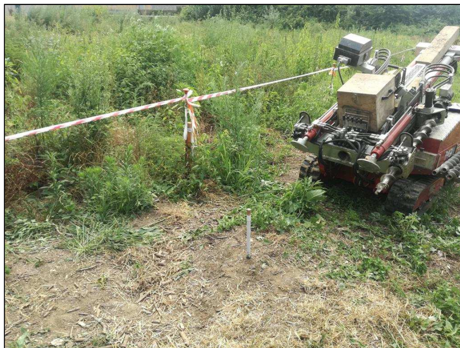
Fig. 8: Completamento piezometro prova PD.2
