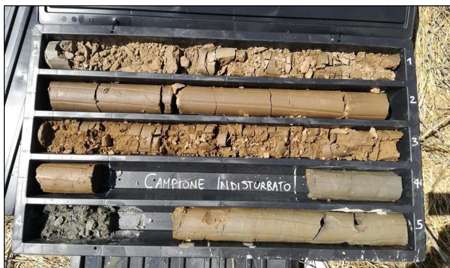
Fig. 2: Sondaggio S1-Pz – Cassetta 1 (0,00 – 5,00 metri)
